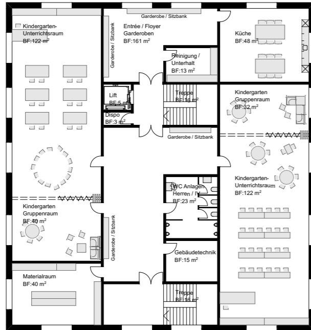
GRUNDRISS 3. OBERGESCHOSS | 1:330 NUTZUNG KINDERGARTEN | (Wenn Aufstockung realisiert wird ggf KIGA in 2. OG)
